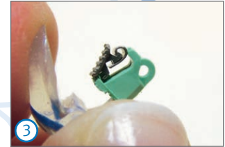
3 Bracket in Quickhülle einsetzen
